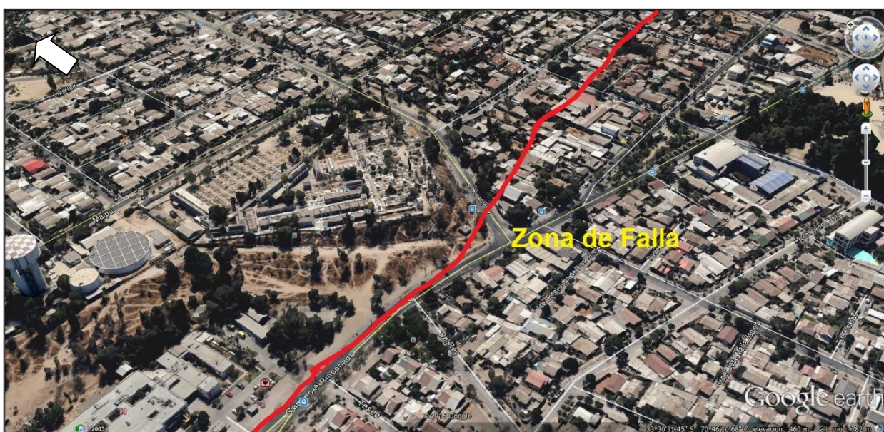
Figura 2. Imagen satelital donde se detalla un lineamiento asociado a Falla, en línea roja, que se dispone NE-SW, entre el Hospital el Carmen-Cementerio y la calle Ordoñez hacia el NE. Esta falla es responsable de la diferencia de cota entre la zona al S de Calle 5 de Abril y la zona de la Calle Victoria-Ordoñez, hacia el norte. Notar que estos suelos del sector se componen de tobas de cenizas-pómez, de mala respuesta sísmica. Tomado desde Google Earth.
